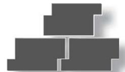
**CROISER** les joints du rang inférieur à mi-distance des joints du rang supérieur afin d'éviter les alignements.
