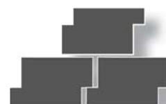
**CROISER** les joints du rang inférieur à mi-distance des joints du rang supérieur afin d'éviter les alignements.
