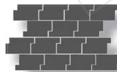
**EMBOÏTER** les plaques les unes avec les autres permet de réaliser un montage rapide des rangs.
